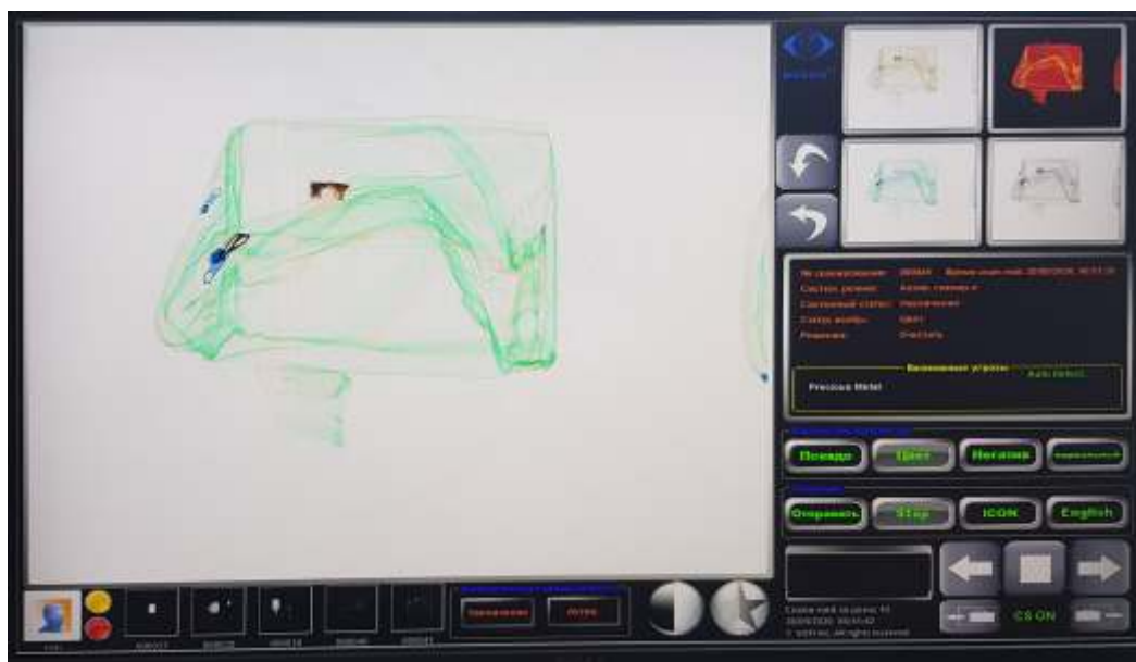
Рисунок 12 Автоматическое обнаружение небольшой закладки с золотом (концентрат) в сумке.
