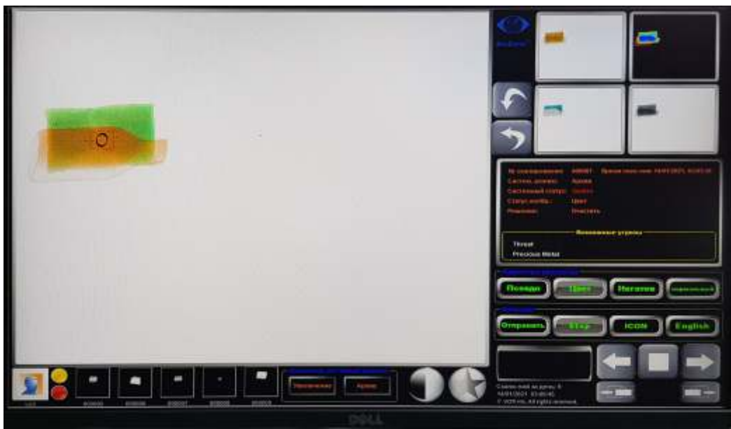
Рисунок 9 Автоматическое обнаружение золотого кольца, спрятанного в пластиковой бутылке.
