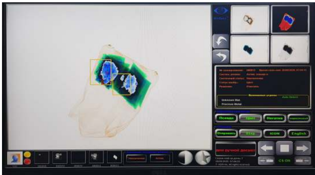
Рисунок 10 Автоматическое обнаружение небольших закладок с золотом (стружка) в пакете с мусором.
