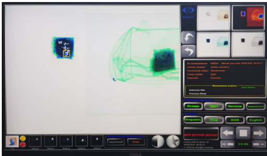
Рисунок 11 Автоматическое обнаружение сверхмалой частицы золота в пакете с мусором.
